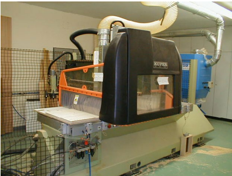
Abbildung 7: CNC-Maschine mit Rastertisch und Werkzeugwechsler L. Hovestadt
